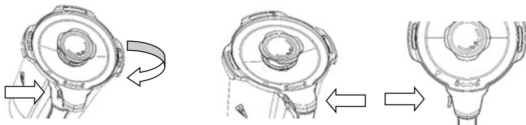
Placez le bocal sur le bloc-moteur dans le bon sens et fixez-le correctement, sinon le moteur ne peut pas démarrer.
