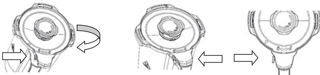
Coloque la jarra sobre la unidad principal con el asa en la dirección correcta y encájela de forma segura, de lo contrario, el motor no podrá arrancar.
