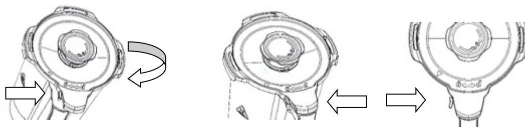
Setzen Sie den Behälter ordnungsgemäß in die richtige Richtung auf die Haupteinheit, damit der Motor gestartet werden kann.
