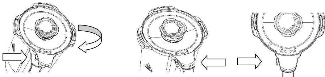
Coloque o recipiente de cozinhar na estrutura principal do aparelho, na posição correcta e encaixado apropriadamente, caso contrário o motor não pode começar a funcionar.
